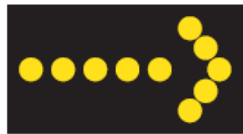
Figura 5.3-12 Flechas Direccionales Luminosas
